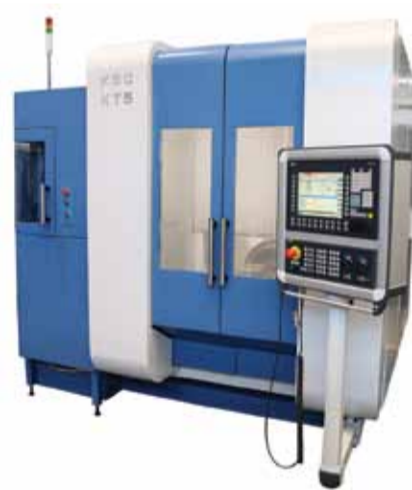
5-ти координатный ОЦ консольного типа КВС КТ5
