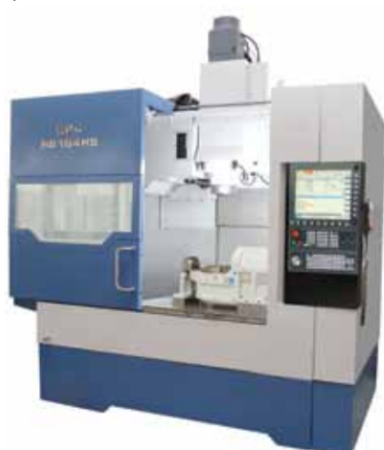
Вертикально-фрезерный ОЦ КВС MB 184M5 с отечественной системой ЧПУ «ОЛИМП»
