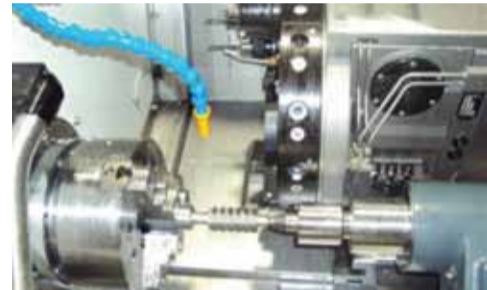
Рис. 8. Процесс изготовления червячного вала на токарном станке
