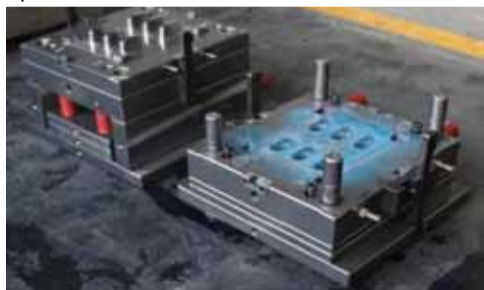
Рис. 2. Матрица и пуансон пресс-формы, изготавливаемые на станке ACCUTEX AU-300ia
