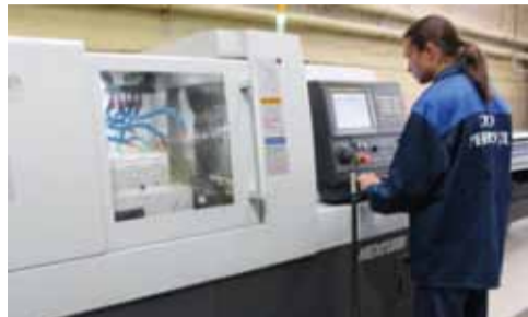
Рис. 3. Автомат продольного точения Nexturn, используемый на предприятии
