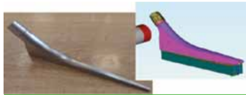
Рис. 6. Проектирование УП обработки импланта и готовый имплант
