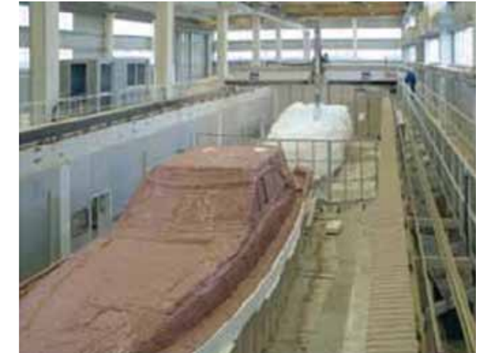
Рис. 5. Две матрицы на разных стадиях изготовления в рабочей зоне станка
