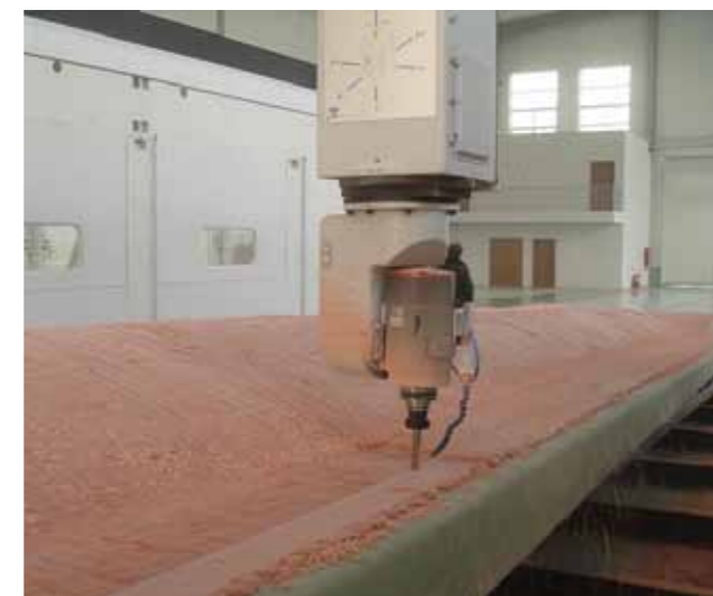
Рис. 4. Высокоскоростное фрезерование матрицы
