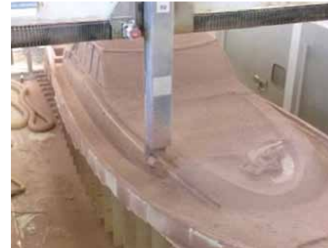
Рис. 4. Высокоскоростное фрезерование матрицы
