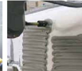
Рис. 3. Нанесение пасты в автоматизированном режиме
