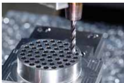
Рис. 1: Современные сверла с тремя режущими кромками позволяют достичь увеличения подачи на оборот на 50%, в том числе при обработке вязких и нержавеющей сталей
