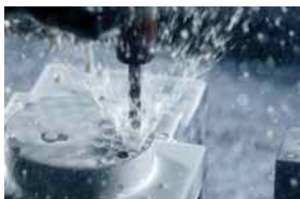
Рис. 1: Современные сверла с тремя режущими кромками позволяют достичь увеличения подачи на оборот на 50%, в том числе при обработке вязких и нержавеющей сталей
