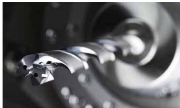
Модульные сверла системы KenTIP FS имеют цельную твердосплавную головку, что позволяет им выдерживать более высокие температуры и нагрузки Kennametal
