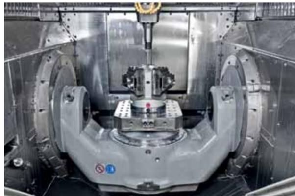
Рабочая зона 5-осевого высокопроизводительного обрабатывающего центра C 22 U, оборудованного наклонно-поворотным столом с ЧПУ диаметром 320 мм, на котором установлена многопозиционная зажимная система (0877) © Hermle AG
