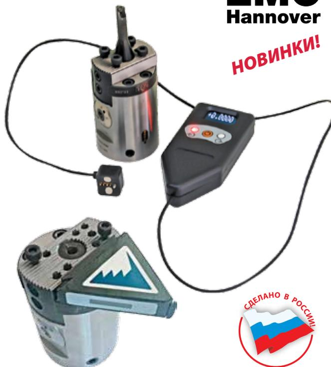
2) Внешнее измерительное устройство «Пирамида». Это универсальное многофункциональное измерительное устройство для оценки перемещений элементов технологической оснастки, позволяющее превратить обыкновенную механическую расточную головку в электрическую головку с цифровой индикацией. Разработка уникальная и не имеющая аналогов в мире, подана заявка на выдачу патента.
