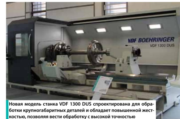
Новая модель станка VDF 1300 DUS спроектирована для обработки крупногабаритных деталей и обладает повышенной жесткостью, позволяя вести обработку с высокой точностью
