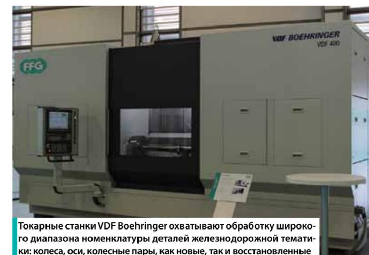
Токарные станки VDF Boehringer охватывают обработку широкого диапазона номенклатуры деталей железнодорожной тематики: колеса, оси, колесные пары, как новые, так и восстановленные
