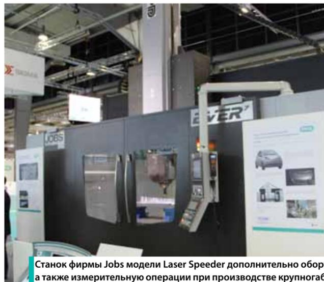
Станок фирмы Jobs модели Laser Speeder дополнительно оборудован лазерной головкой, позволяющей вести наплавку, закалку, а также измерительные операции при производстве крупногабаритных штампов и пресс-форм автомобильной промышленности
