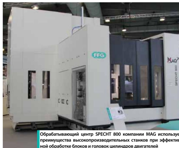
Обрабатывающий центр SPECHT 800 компании MAG использует преимущества высокопроизводительных станков при эффективной обработке блоков и головок цилиндров двигателей
