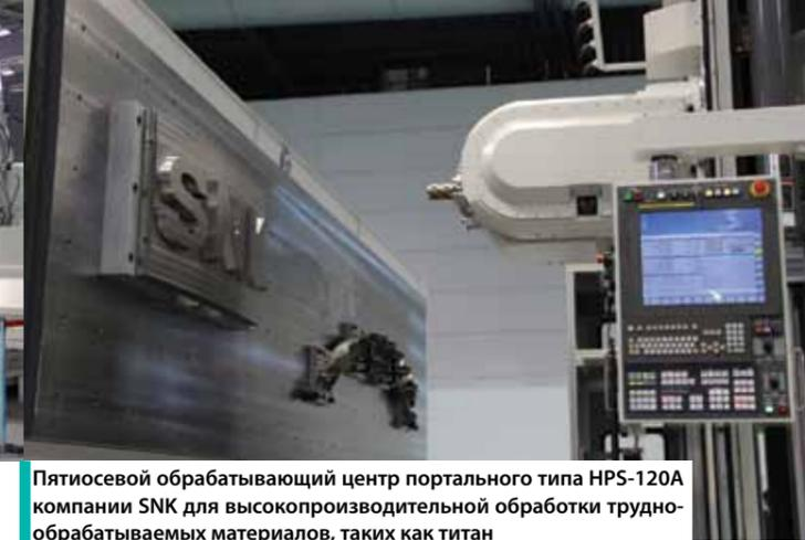
Пятиосевой обрабатывающий центр портального типа HPS-120A компании SNK для высокопроизводительной обработки труднообрабатываемых материалов, таких как титан
