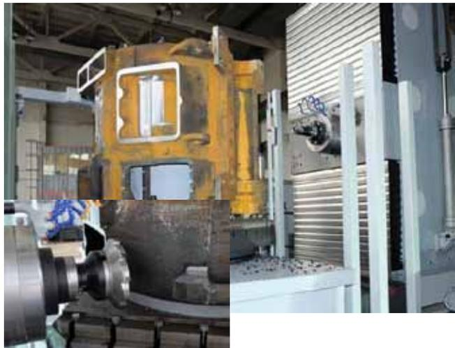
Спроектирован, изготовлен и сдан заказчику специальный фрезерный станок модели SMS0064F2 для обработки остовов тяговых электродвигателей.
