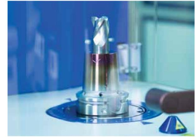
*С помощью балансировочной машины HAIMER Tool Dynamic Comfort отслеживается качество балансировки G и корректируется на 2.5 на 33,000 1/мин*
