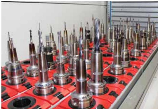
*Сбалансированный инструмент доступен в инструментальном цехе в любое время.*
