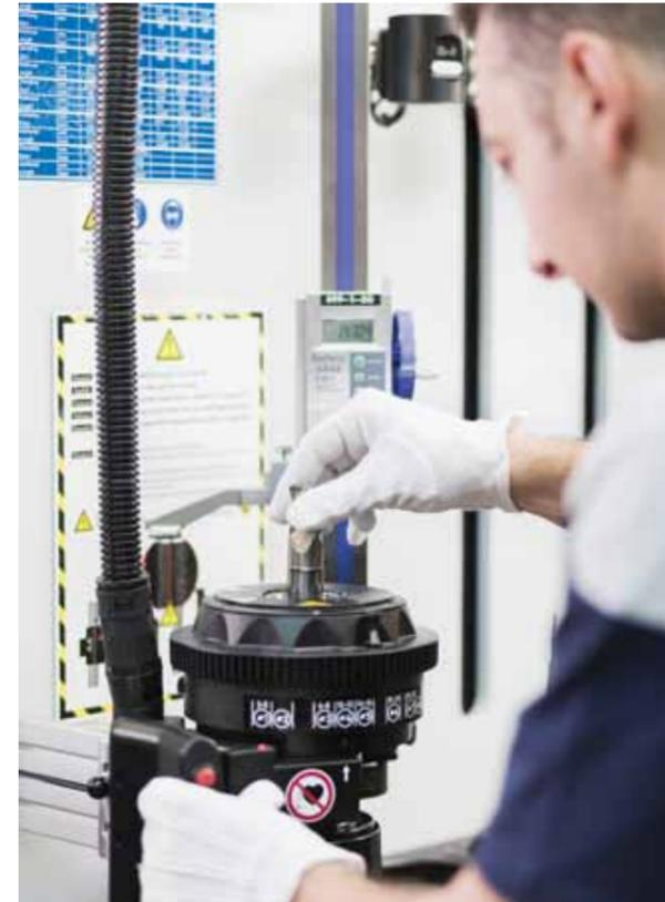
*Простой и легко повторяемый процесс термоусадки: параметры для каждого термопатрона фирмы HAIMER уже интегрированы в термоусадочное устройство фирмы HAIMER Power Clamp Premium*
