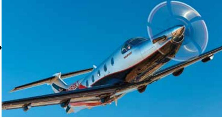
*Многоцелевой самолет Pilatus Turboprop PC12, как и все остальные воздушные суда фирмы Pilatus, в основном состоит из алюминиевых структурных компонентов*
