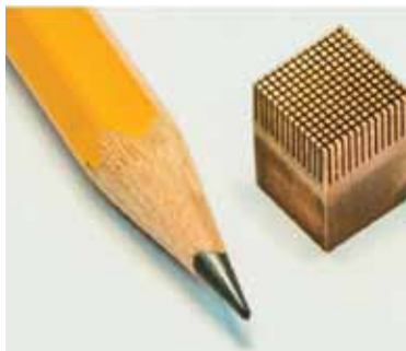
Микроэрозионная обработка на станке АРТА 123 ПРО. Изготовление электрода из эльконайта (вольфрамо-медный сплав) для последующей прошивки титановых пластин
