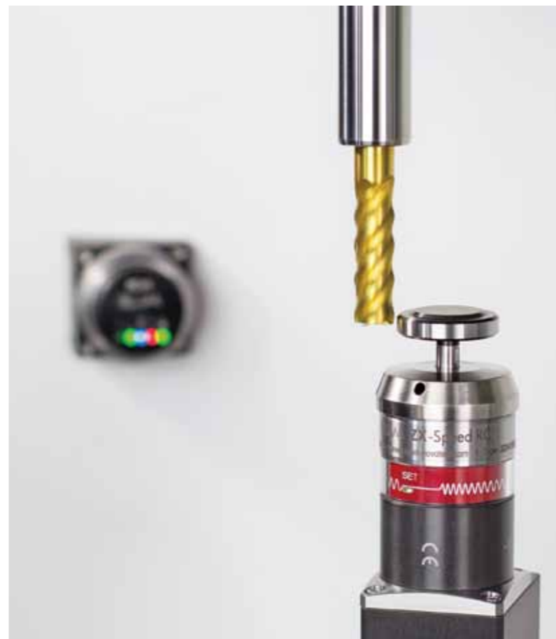
Рис. 2. Щуп ZX-Speed RC с радиопередачей используется если не может быть обеспечена линия прямой видимости к приемнику. Как и все системы данной серии, он применяется для настройки инструмента по длине и в радиусе, а также для контроля поломки инструмента.
