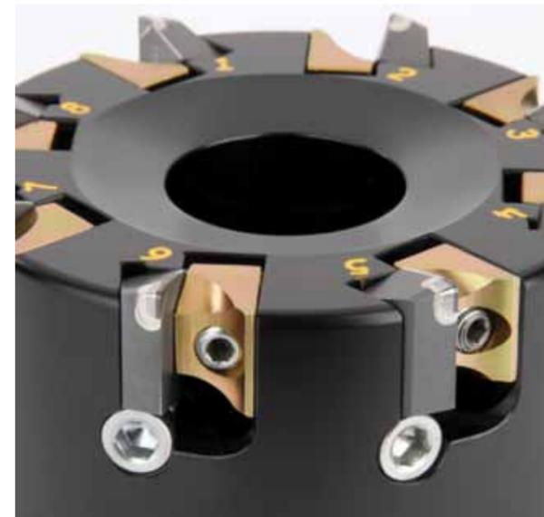
Закрепить пластины KBDM очень просто. Возьмите в руки оптический прибор для предварительной настройки и НЕ ПЕРЕТЯГИВАЙТЕ!
