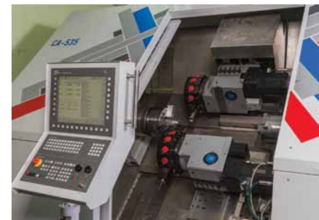
СЧПУ «Перспектива» на токарно-фрезерном станке производства ОАО «САСТА» (Рязанская обл.)
