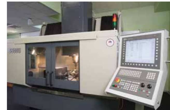
СЧПУ «Перспектива» на 5-координатном вертикально-фрезерном ОЦ производства компании НПО «Станкостроение»
