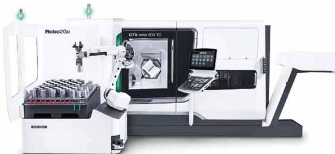
Компания DMG MORI представит мобильную систему автоматизации Robo2Go для токарных центров, простую и удобную в программировании благодаря интерфейсу CELOS® на основе приложений
