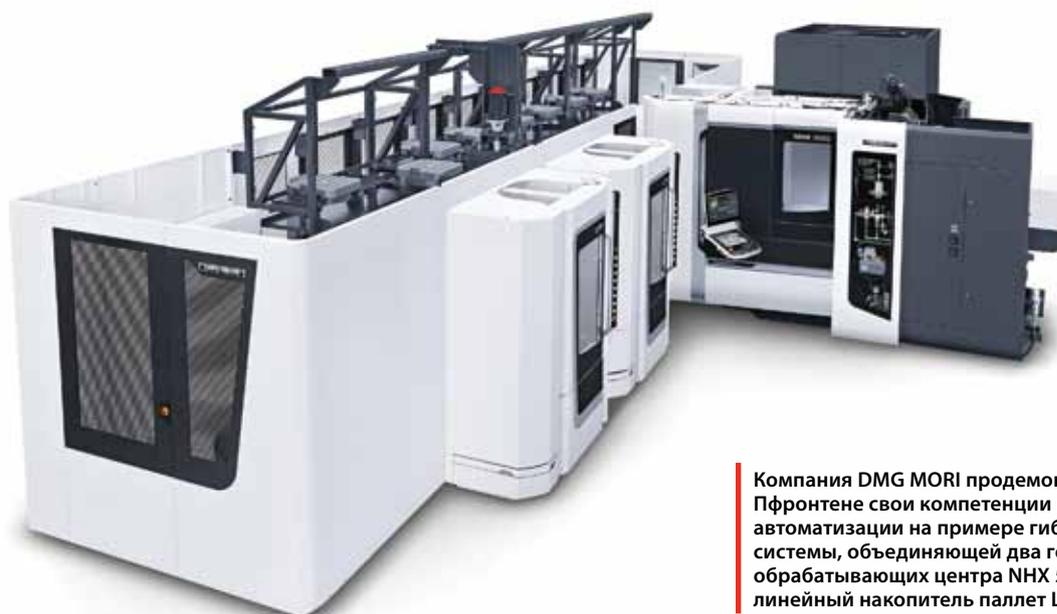
Компания DMG MORI продемонстрирует в Пфронтене свои компетенции в области систем автоматизации на примере гибкой производственной системы, объединяющей два горизонтальных обрабатывающих центра NHX 5000 и DMC 60 H linear и линейный накопитель паллет LPP 24
