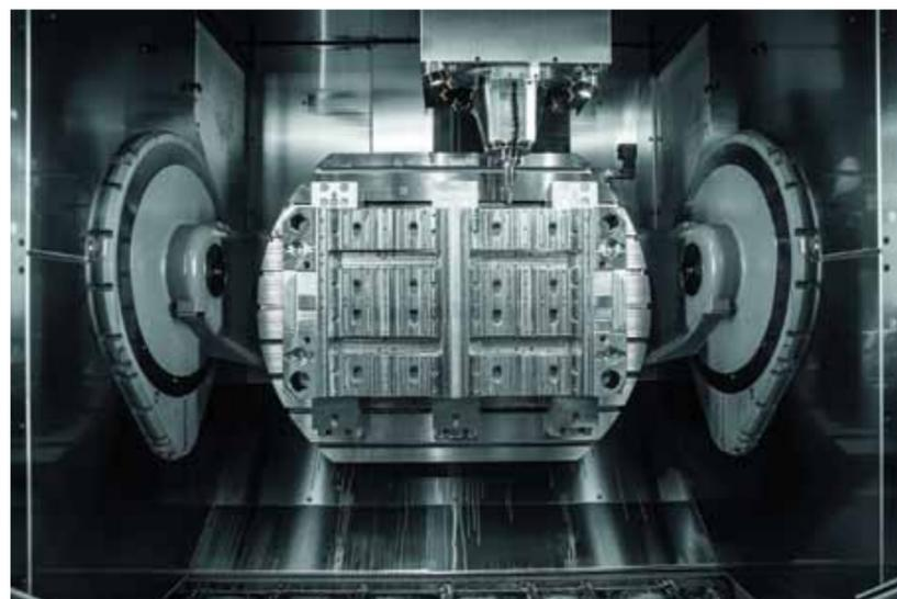
Рабочая зона высокопроизводительного 5-осевого обрабатывающего центра с ЧПУ C 52 U с наклонно-поворотным столом 1150x900 мм для крупных деталей массой до 2000 кг
