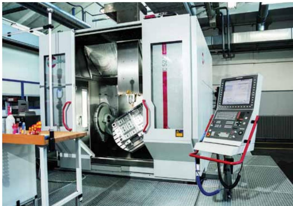
Самый большой высокопроизводительный 5-осевой обрабатывающий центр с ЧПУ C 52 U, используемый для комплексной обработки деталей диаметром до 1000 мм и высотой 810 мм
