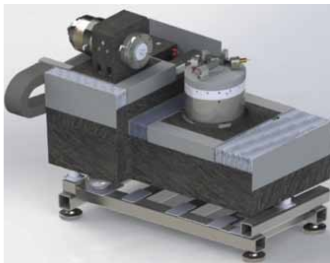
Рис. 2. Стенд для сверхточного алмазного точения сферических и асферических поверхностей
