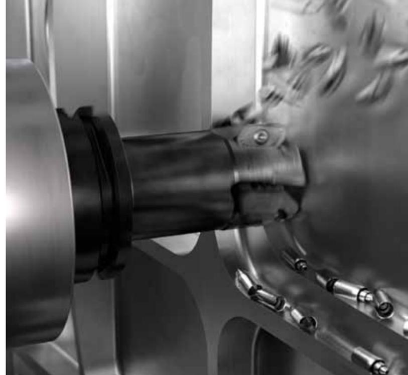
Фреза RAL90 для высокоскоростной обработки алюминия
