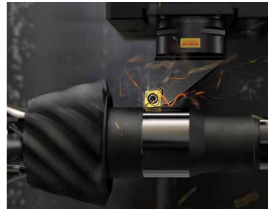
Твёрдое точение пластиной из нового сплава CB7105
