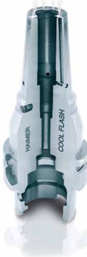
*Стойкий силовой термопатрон HAIMER также есть в исполнении с системой Cool Flash. Инструменты без внутреннего подвода СОЖ имеют то преимущество, что охлаждающая жидкость подается от инструмента до реза. За счёт этого улучшается процесс обработки.*
