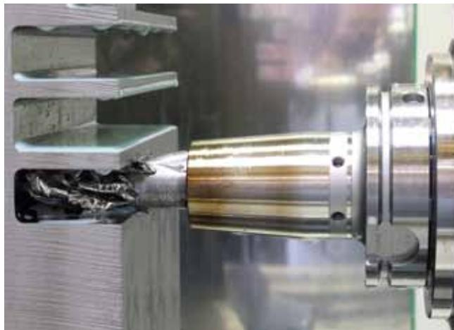
*Черновая обработка титана: без системы Safe-Lock инструмент вылетел из стандартного патрона и сломался при  $ap = 2xD$ . С инструментальной оправкой HAIMER системы Safe-Lock серии Power и HeavyDuty надёжно были фрезерованы пазы с  $ap = 2xD$*
