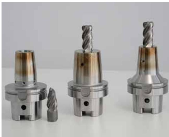
*Рядом с термоусадочным патроном со стандартным размером находится термопатрон HeavyDuty (в середине) и силовой термопатрон (справа). Эти два патрона могут быть оборудованы системой Safe-Lock против вытягивания инструмента. Это сочетание приводит к наиболее высокой точности биения при совершенно надёжном процессе обработки и защите против вылета инструмента.*
