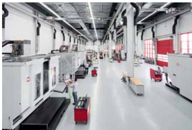
Производственно-сборочный цех № 19. На переднем плане сборка нескольких 5-осевых обрабатывающих центров С 60
