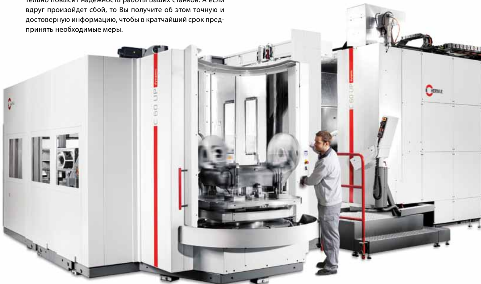
Станок C 60 UP динамич с устройством смены паллет PW 3000 для автоматизированного производства с контролем производственных состояний посредством HIMS
