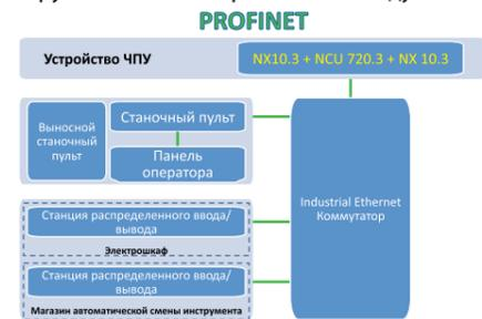
Для подключения периферийных устройств используются станции распределенного ввода/вывода ET200M (шкаф) и PP 72/48 (магазин). Станочный пульт – MCP 483C PN; ОП – OP015AT TCU, 15 дюймов; кнопочная ВСП – НТ2 С ДИСПЛЕЕМ.
