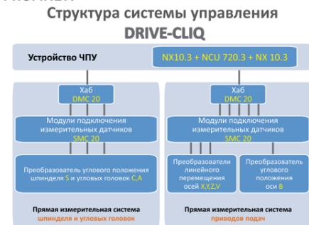
В качестве прямой измерительной системы шпинделя S выбран энкодер ЛИР 250 фирмы СКБ ИС (Россия), угловые головок С, А – энкодер серии SP, фирмы Faqor.
