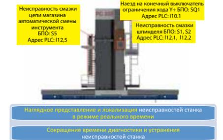
Наглядное представление и локализация неисправностей станка в режиме реального времени. Сохранение времени диагностики и устранение неисправностей станка.
