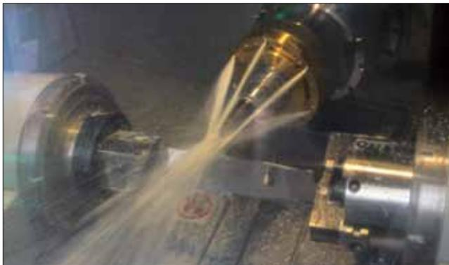
Фрезерование лопатки на станке МШ-600
