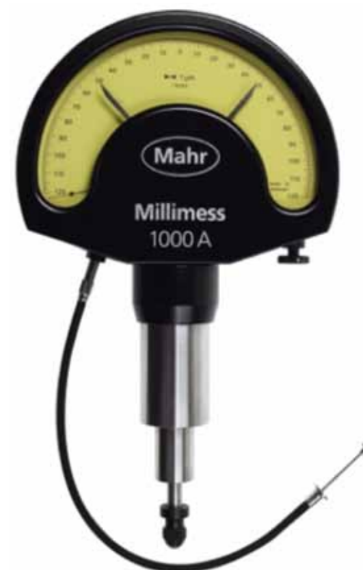
Рычажно-зубчатая измерительная головка Millimess 1000 A с ценой деления 0,001 мм и посадочной гильзой Ø28 мм
