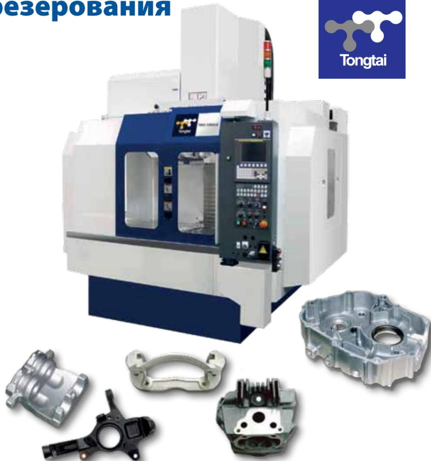
режущих операций и повторяемости результатов. При проектировании станка применялся метод конечных элементов (FEM), который позволил добиться структурной целостности конструкции, а также повышенной устойчивости и производительности станка, что повышает точность позиционирования во время высокоскоростной обработки.
