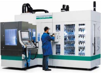
высокой точности, которые необходимы при изготовлении инструментов, можно выполнить в циклах сверления и фрезерования. Крупные объемные формы даже из труднообрабатываемых инструментальных сталей фрезеруются с прецизионной точностью. Для загрузки краном достаточно простого открытия дверей оператора. Устройство для смены паллет устанавливается на заводе-изготовителе или его можно смонтировать позднее.
