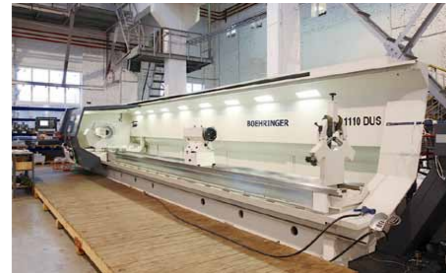
Станок VDF Boehringer DUS 1110 с ЧПУ Sinumerik 840D sl
