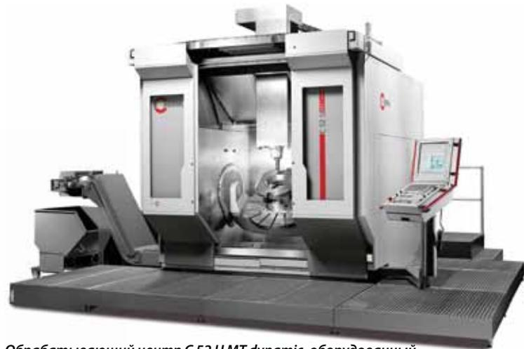
**Обработка центр C 52 U MT dynamic, оборудованный наклонно-поворотным столом Ø 1000 мм и системой управления Heidenhain TNC 640**
