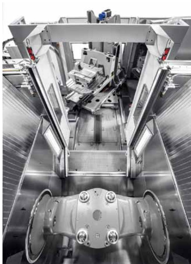
Обработка центр C 52 UP dynamic с устройством смены палет PW 3000 в процессе загрузки
