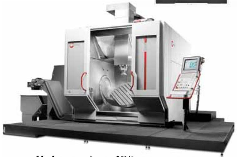
**Обработка центр C 52 U с наклонно-поворотным столом Ø 1150 мм и системой управления Heidenhain TNC 640**
