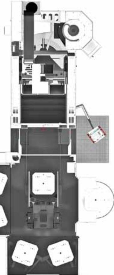
**Обработка центр C 52 UP dynamic, оборудованный устройством смены палет PW 3000 с 4 ячейками палет, станцией оснастки и одинарным дополнительным магазином**
