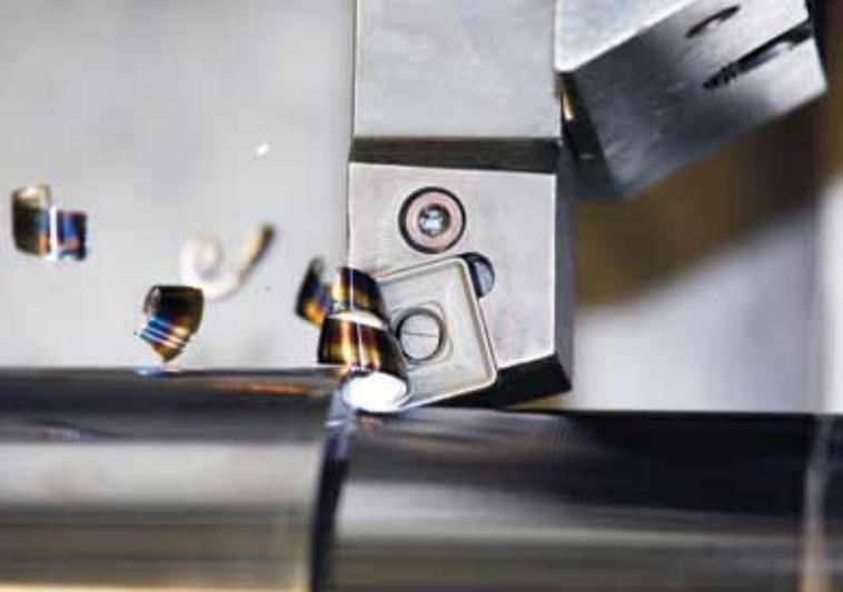
Специальная обработка поверхности пластин способствует снижению вероятности налипания стружки и образования термотрещин.
