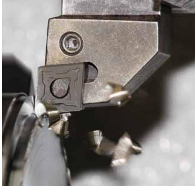
Геометрии *W-FM* и *W-NM* с зачистной кромкой *Wiper* способствуют повышению производительности и качества обработки
