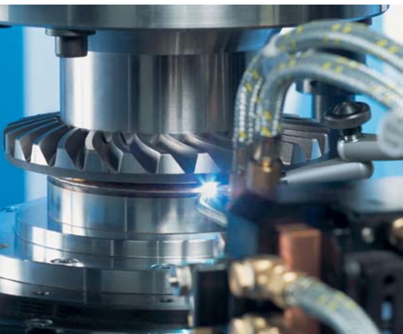
Лазерная сварка ведомой конической шестерни главной передачи и корпуса дифференциала
