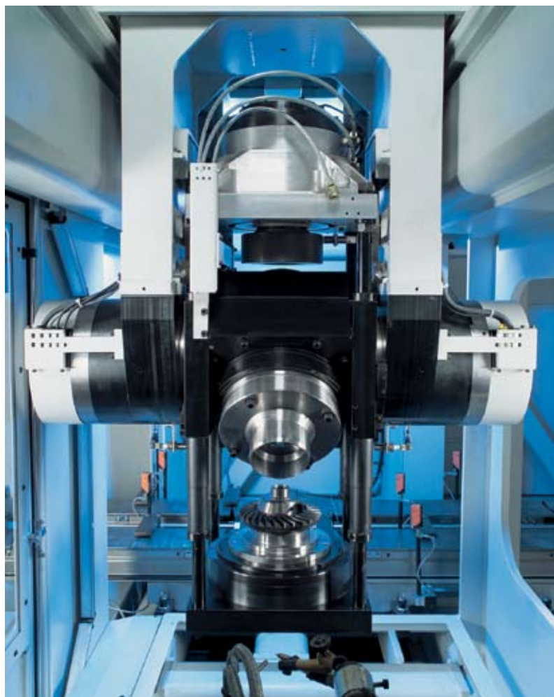
Установка ELC 250 DUO оснащена двумя поворотными «Pick-Up»-шпинделями, самостоятельно захватывающими деталь
