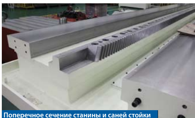
Поперечное сечение станины и саней стойки
