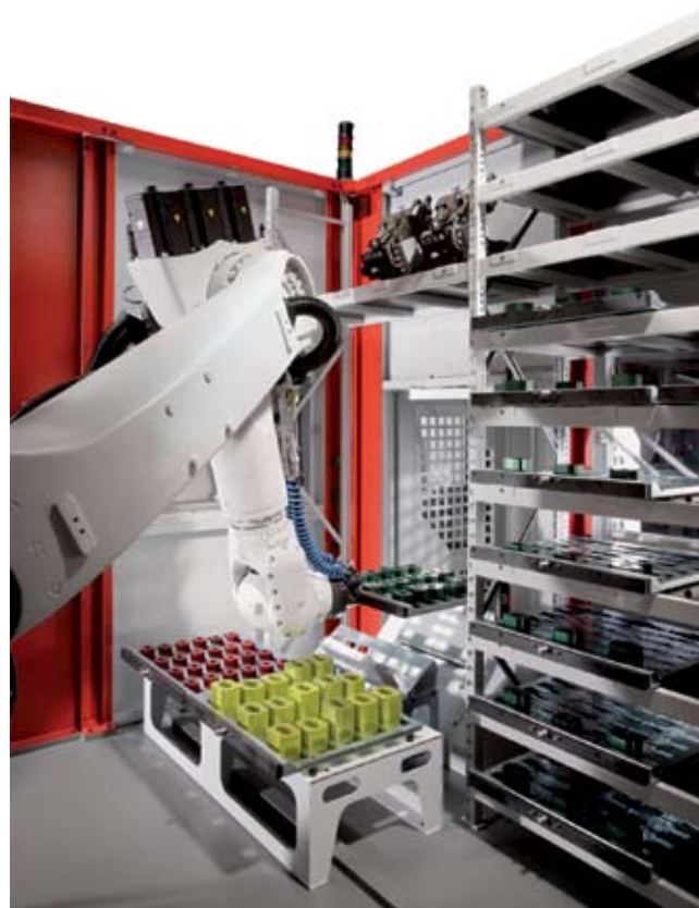
Рис. 4. Роботизированная система RS 2 адаптирована к двум обрабатывающим центрам С 40 U dynamic. Один робот обслуживает два станка. При этом возможна работа параллельно на обоих станках в ручном или автоматическом режиме.
