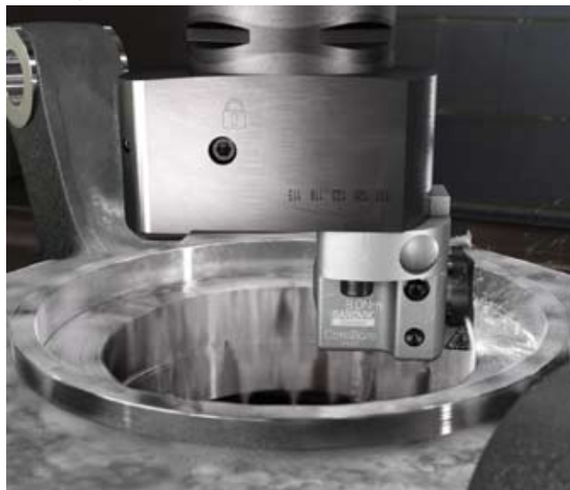
Система CoroBore® 826 HP с уникальной высокоточной (HP) подачей СОЖ на режущую кромку
