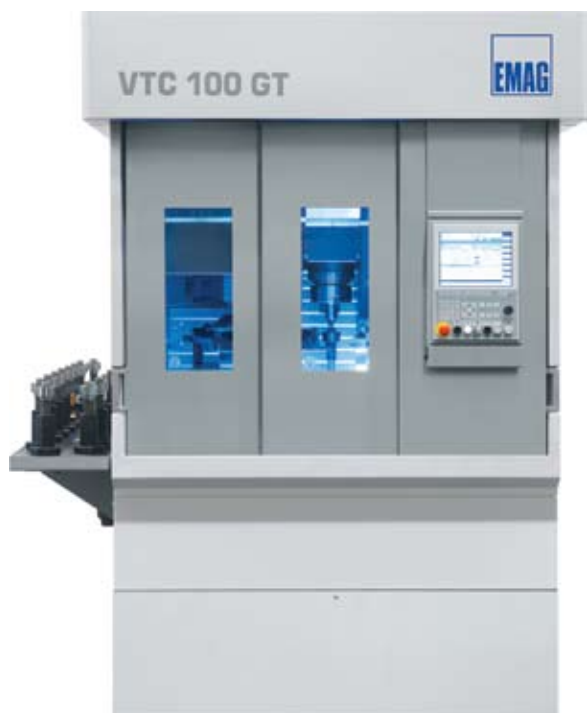
VTC 100 GT – это вертикальный производственный центр для комбинированной токарно-шлифовальной обработки
