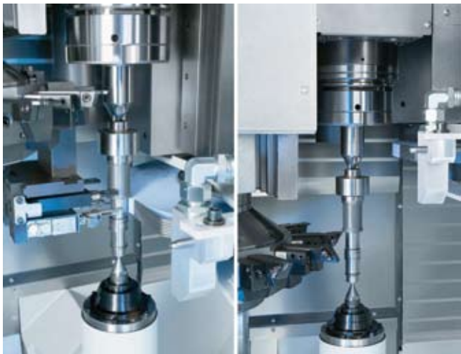
Рабочая зона станка VTC 100 GT: все процессы чистовой обработки (шлифование с кругами CBN, твердое точение и «бреющее» точение с минимальным припуском) выполняются за один установ детали
