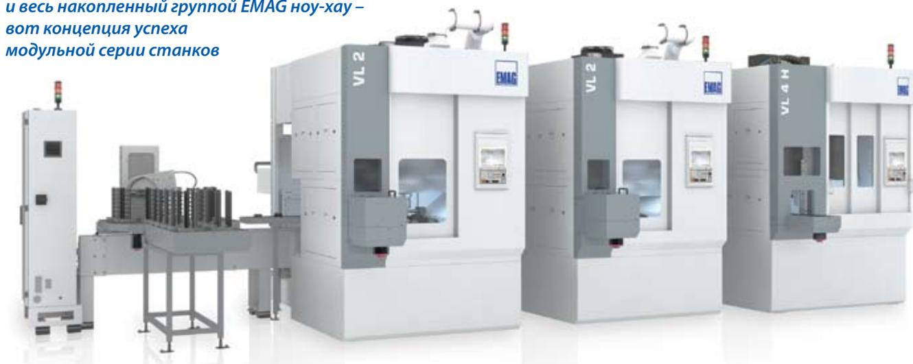
В системе автоматизации TrackMotion транспортный модуль TransLift перемещается сквозь станки по единой рельсовой направляющей
