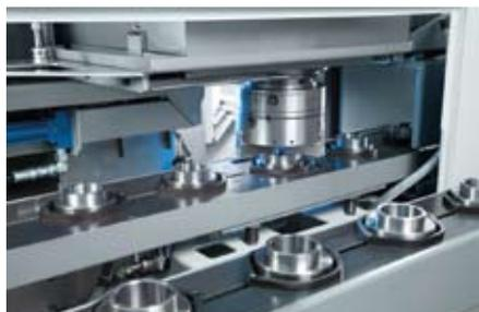
Встроенная “Pick-up”-автоматизация, состоящая из накопителя деталей и “Pick-up”-шпинделя, обеспечивает минимальное время “от стружки до стружки”
