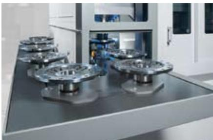
Модульные станки серии VL обеспечивают возможность обработки деталей диаметром до 400 мм
