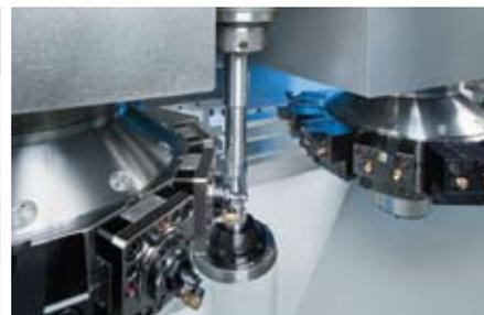
Обработка валов на станках серии VT производится по 4-м осям ЧПУ, что позволяет сократить время обработки
