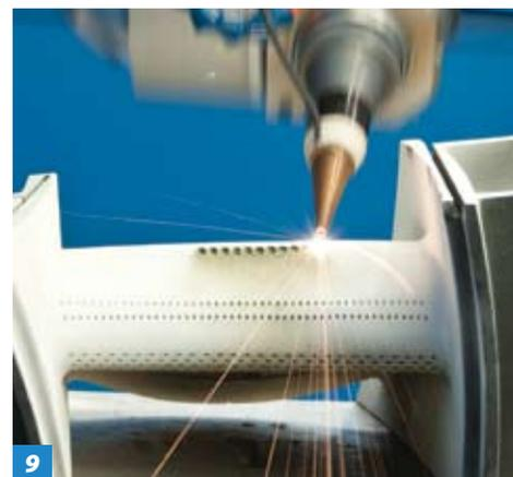
(Фото 8 и 9): Проектировка и создание охлаждающих отверстий важны для производительности аэрокосмических двигателей. Двигатели нового поколения должны иметь более сложные охлаждающие отверстия, которые должны быть расположены как можно ближе друг к другу. Данные охлаждающие отверстия имеют малый диаметр (0,5-0,75 мм) и располагаются под острым углом относительно поверхности детали. Только благодаря лазерным системам нового поколения можно эффективно и экономично создать такие отверстия.
