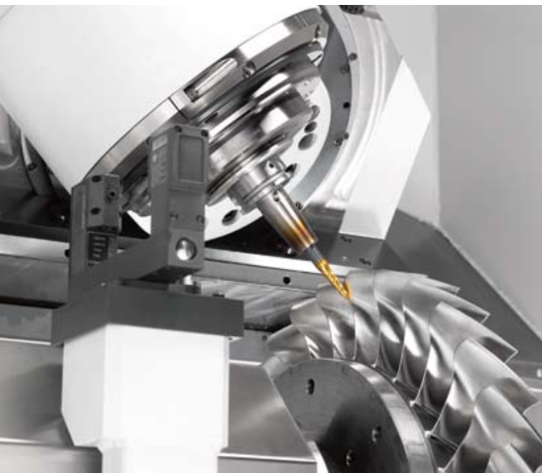
Starrag Group, как многолетний партнер двигателестроительной промышленности, компетентен в разработке сложных производственных решений по изготовлению элементов турбин. Типичным примером таких инвестиций в оборудование является термоусадочная техника Haimer.
