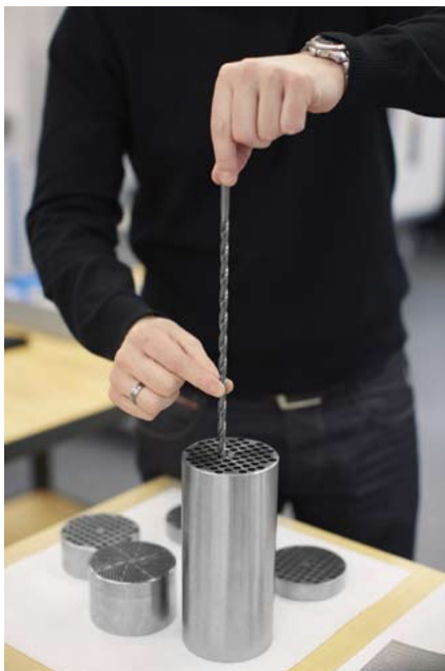
Тест 1: Сверление глубоких отверстий осуществляется в 18 раз быстрее
