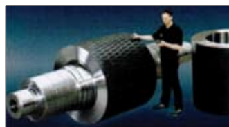
Рис. 9. Плакированный вал для производства цемента (фирма Koppern)
