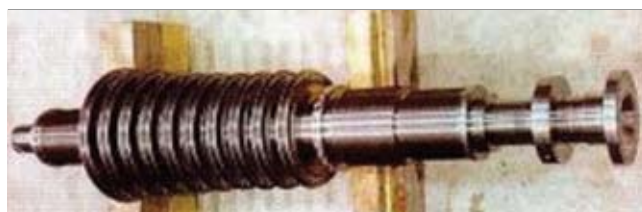
Рис. 6. Роторы для паровых и газовых турбин (фирма Sandvik Powdermet) Материал: порошковая сталь с 12% хрома. Масса изделия до 10 т.
