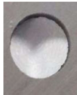
В – качество, полученное при обработке FK-инструментом ГЮРИНГ
