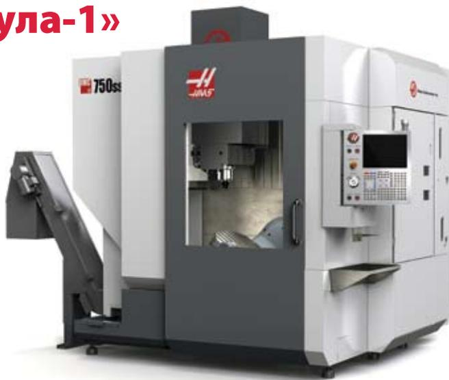
ми 762x508x508 мм, обеспечивает скорость перемещения 30,5 м/мин, а также оснащен встроенным высокоскоростным двухосевым поворотным столом.
