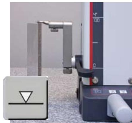
вании высотомера, что было бы идеально, можно было бы просто положить деталь базовой поверхностью на плиту, обнулить основной наконечник прибора относительно плиты и начать проводить измерения длины. Конечно, в жизни не всегда все так просто, но бояться не стоит. Существует много дополнительных возможностей, позволяющих использовать несколько начал отсчета.
