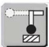
Большинство наборов принадлежностей для высотомеров включают в себя консоли, содержащие два наконечника, расположенные под прямым углом. Горизонтальный наконечник делает большинство работ, тогда как вертикальный задействуется для доступа в глухие отверстия или канавки
