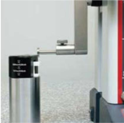
Иногда отверстия не прямолинейные, а конусные, и необходимо измерить их угол конусности. Для этих измерительных задач используется наконечник с цилиндрической контактной поверхностью, обеспечивающий острую кромку для измерения угла конуса
