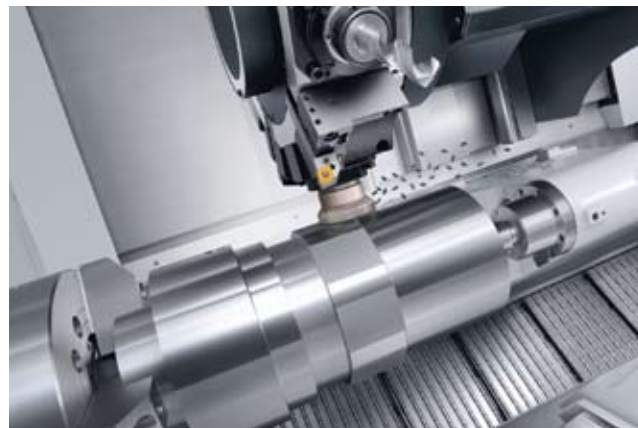
Новый NLX 6000|2000 позволяет выполнять весь спектр токарной обработки длинных деталей большого диаметра - от 2-х осевого точения до 6-сторонней обработки с высокой производительностью
