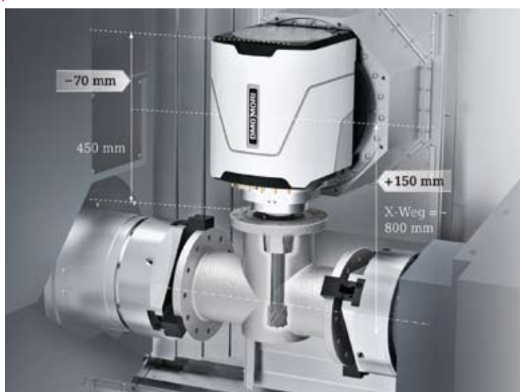
Токарно-фрезерный шпиндель compactMASTER® компании DMG MORI обеспечивает повышение крутящего момента на 130 % до уровня 230 Нм при частоте вращения шпинделя до 12 000 мин -1 .
