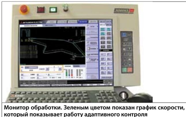
Монитор обработки. Зеленым цветом показан график скорости, который показывает работу адаптивного контроля
