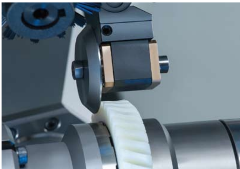
Встроенная вспомогательная ось с ЧПУ служит для крепления роликов для удаления заусенцев и приводных дополнительных инструментов, например, щеток, устройств виброгашения или датчиков.
