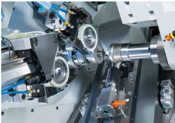
Полностью автоматизированное зубофрезерование с использованием портального загрузочного устройства с V-образным грейфером
