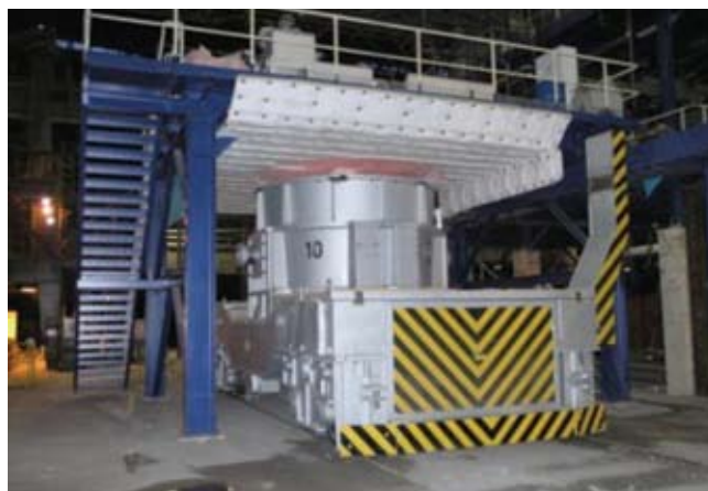
Рис. 4. Стенд нагрева ковшей
