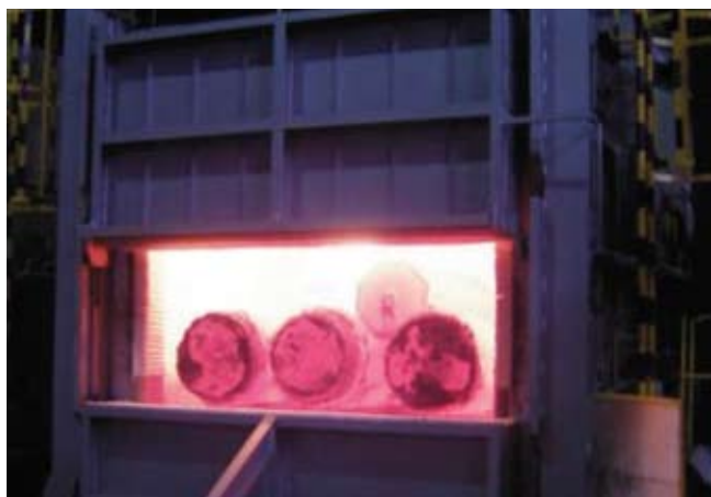
Рис. 3. Печь с выкатным подом 3,4*2*5,7 м с предварительным нагревом воздуха
