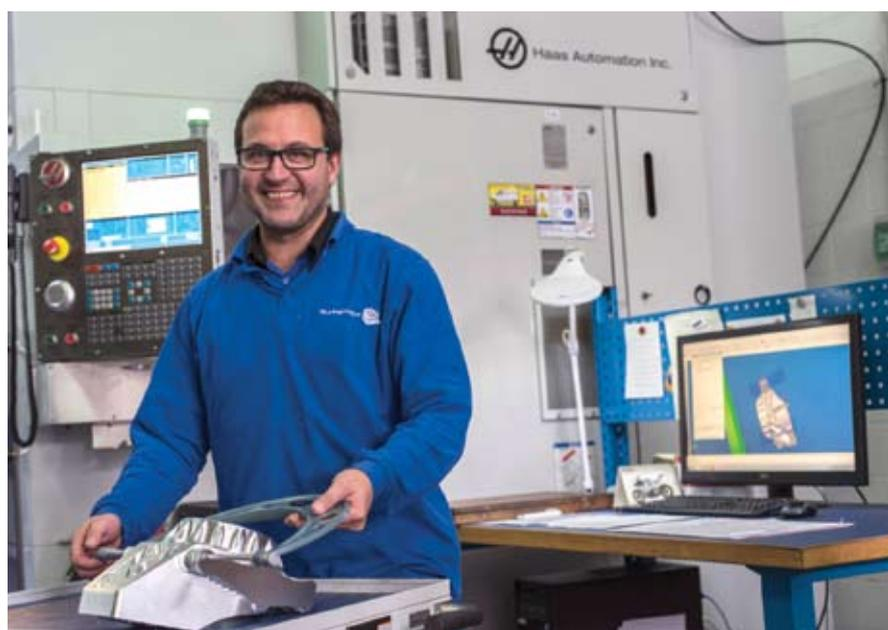
Детали сложной формы, выполненные из магния на станке UMC-750, требуют тщательной обработки множества элементов: выемок, гребней, выпуклостей, углублений неправильной формы, а также наклонных поверхностей, с допуском, иногда не превышающим 0,02 мм
