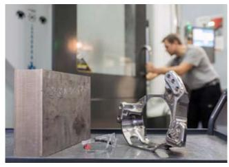
Около 80% деталей, поставляемых компанией КМР, производятся из титана, многие из них весьма сложны, имеют поверхность произвольной формы, в том числе ровные поверхности, наклонные сквозные отверстия и выпуклости неправильной формы
