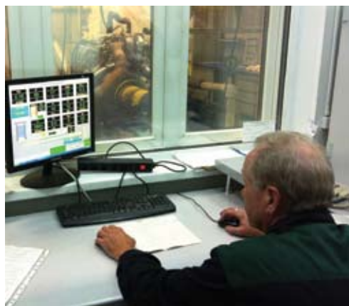
В цехе – станция испытаний разработана и изготовлена полностью специалистами ТМЗ. Испытываются все двигатели, сроки испытаний разные, но в среднем 35 минут горячей обкатки.
