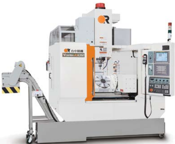
Vcenter-Ax350 5-координатный обрабатывающий центр
